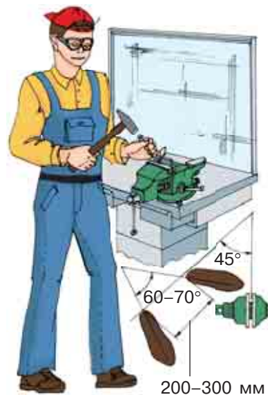
Мал. 111. Положення тулуба (а) та ніг (б) працюючого під час виконання операції рубання зубилом
