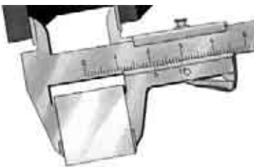
Мал. 127. Приклад використання штангенциркуля для перевірки паралельності та взаємної перпендикулярності сторін деталі
