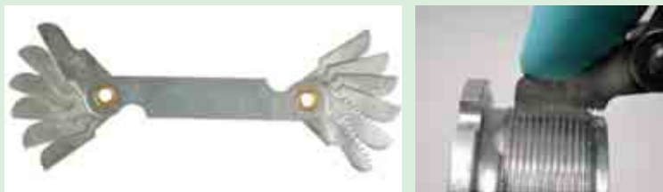
Мал. 164. Різьбовий щуп (а) і спосіб його використання (б)
