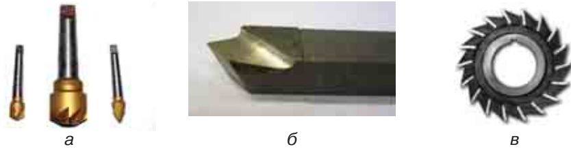
Мал. 23. Інструменти, що виготовляють із швидкорізальних інструментальних сталей: а — зенківки; б — токарний різець; в — дискова фреза
