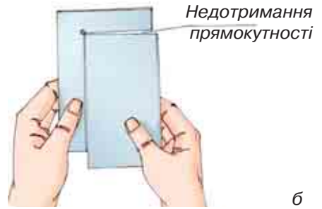
Мал. 125. Контроль зовнішнього кута деталі за допомогою кутника
