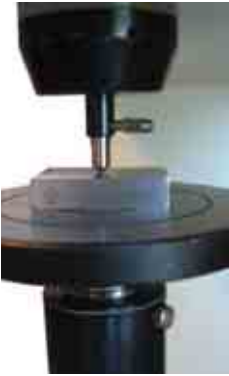
Мал. 28. Вимірювання твердості металу за методом Роквелла
