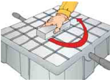
Мал. 134. Правильна плита для точної перевірки площинності обпиленої деталі
