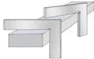
Мал. 126. Перевірка якості обпилювання поверхонь і дотримання прямих кутів між поверхнями деталі
