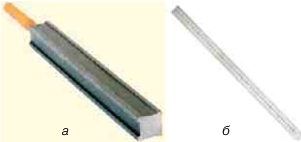
Мал. 131. Інструмент для контролю форми обпиленої поверхні : а — лекальна лінійка; б — слюсарна лінійка
