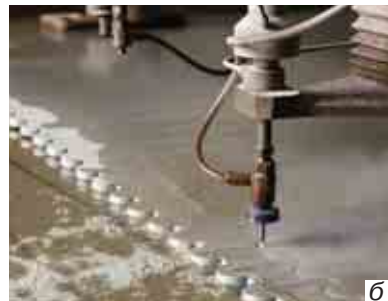
Мал. 89: а — деталі з металу в повсякденному житті й на виробництві; б — різання водою (гідроабразивне різання)
