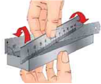
Мал. 132. Перевірка слюсарною лінійкою якості обпилювання поверхні «на просвіт»
