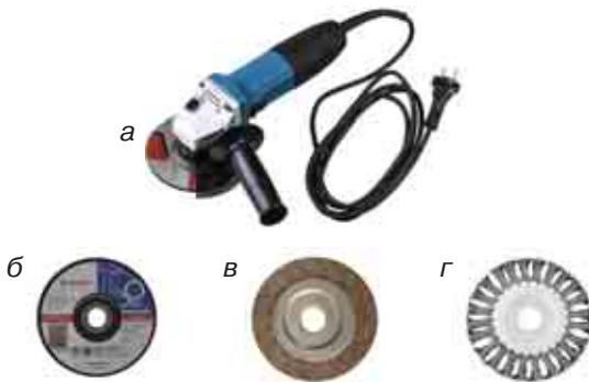
Мал. 191. Кутова машина (болгарка) (а) і різальний інструмент до неї (б — круг відрізний по металу; в — диск пелюстковий торцевий; г — щітка кільцева)
