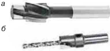
Мал. 141. Циліндричні зенківки з напрямними елементами у вигляді цапфи (а) або спірального свердла (б)
