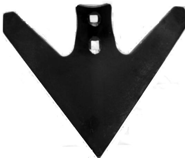
Рисунок. 2. Лапа культиватора, зміцнена до проведення випробувань (а) і після випробувань (б)
