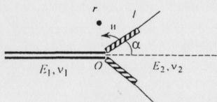
Поскольку в зоне предразрушения преобладающие деформации развиваются по механизму отрыва, полоску-зону будем моделировать линией разрыва нормального смещения, на которой нормальное напряжение равно заданной постоянной материала связующего слоя  $\sigma$ .
