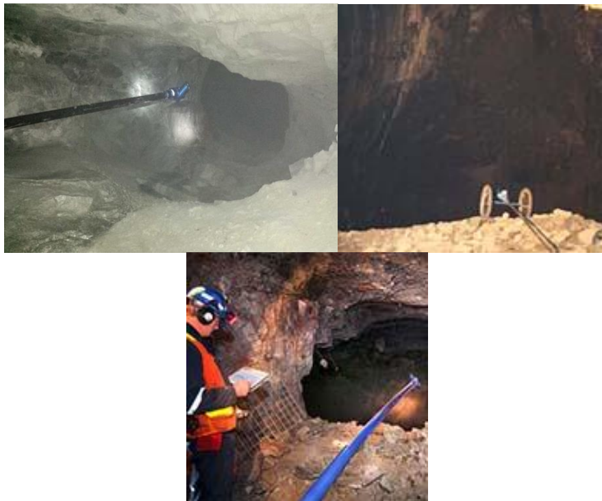
Рисунок 3 – Методы сканирования с применением телескопических труб и специальной системы тележек компании GeoSigh («GeoSigh Buggy System»)
