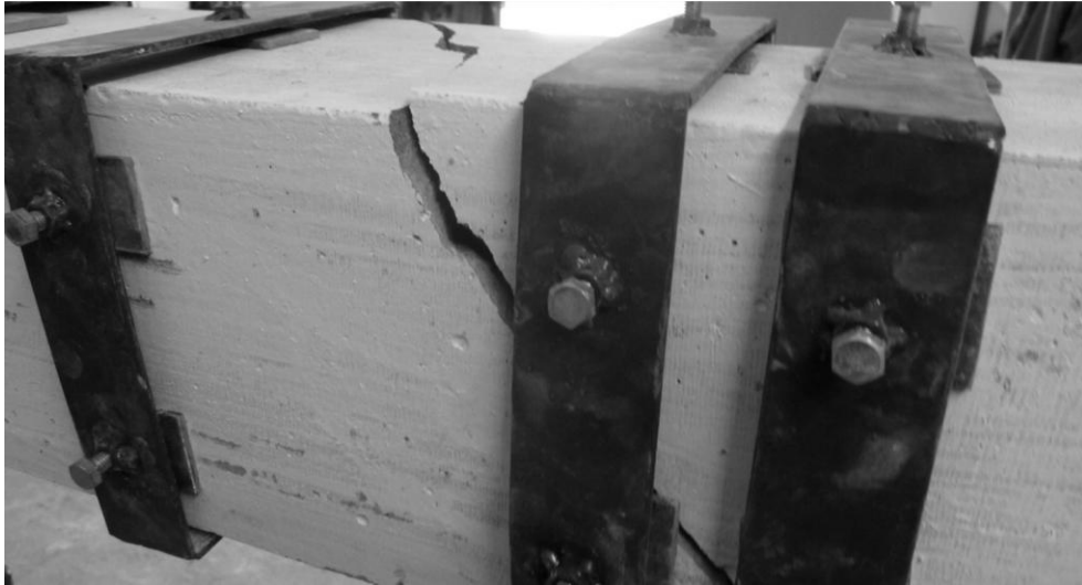
Рис. 3.13. Схема руйнування зразка типовою тріщиною відриву
