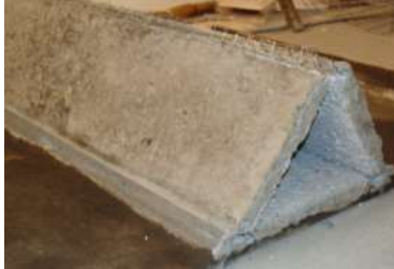
Рис. 10 Збірно-монолітна конструкція порожнистого трикутного перерізу
