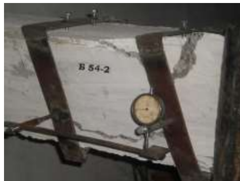
Рис. 7 Схема руйнування експериментальних балок – по просторовій тріщині кручення в верхній полиці (на прикладі балки B 54-2).
