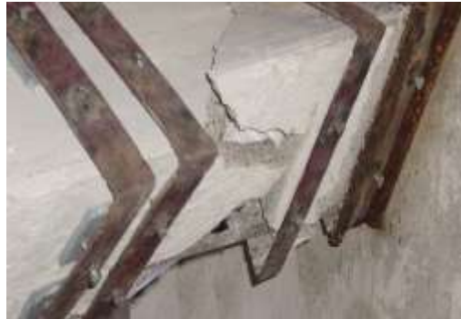
Рис. 6 Схема виколювання арматури експериментальної балки
