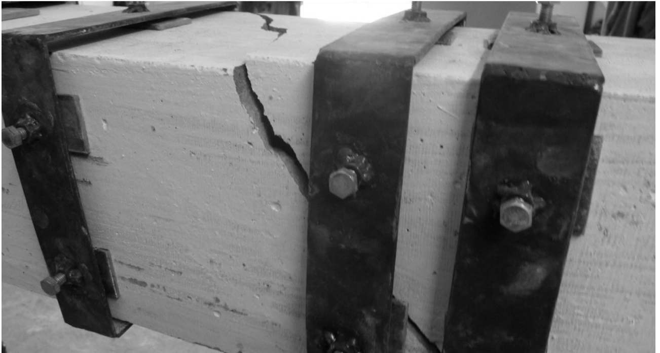
Рис. 3.22. Схема руйнування зразка типовою тріщиною відриву
