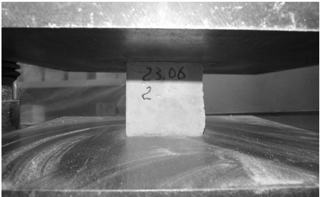
Рис. В.3.1. Експериментальні зразки до прикладання навантаження: а) зразок №1; б) зразок № 2.
