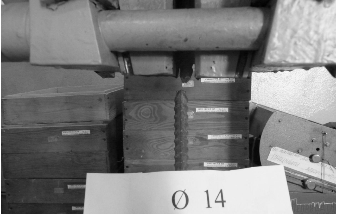
Рис. В.4.1. Випробування арматури на розтяг: а) зразки арматури; б) випробування на розтяг арматурного стрижня; в) зразок арматури після розриву.
