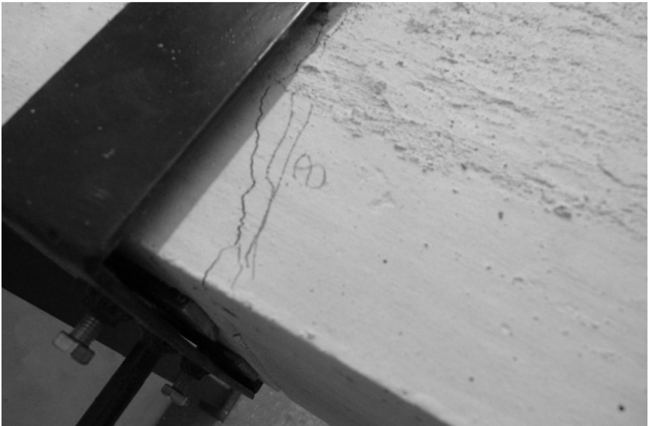
Рис. В.5.2. Поява тріщин в експериментальних зразках (а; б)
