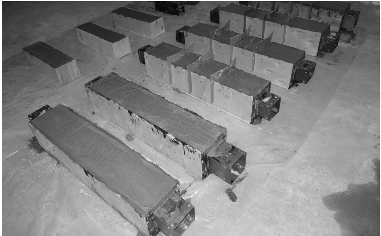
Рис. В.1.1. Виготовлення зразків: а) опалубка; б) заливка бетону у форми.
