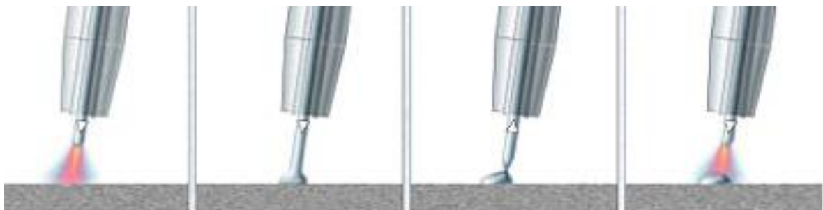
Рис. 1. Принцип процесу СМТ з поступально–зворотним рухом електродного дроту
