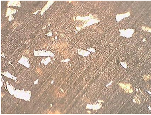
Рис. 3. Поверхні тертя ( \times 200 )металополімерів, що містять: а – 10, б – 15, в – 20, г – 25 мас.% наповнювача після тертя жорсткозакріпленими абразивними частками
