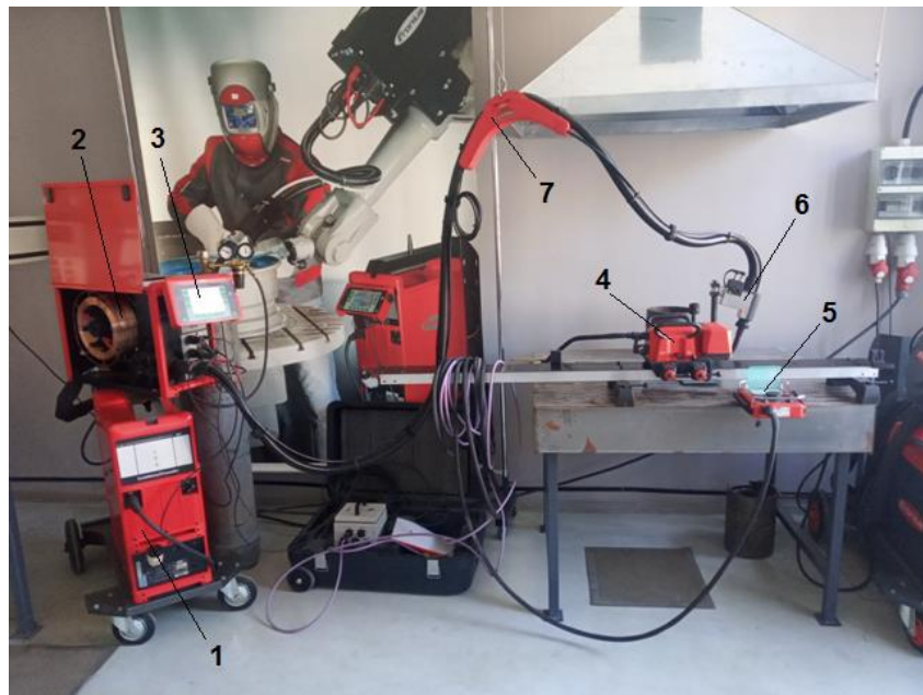
Рис. 2. Загальний вигляд установки для наплавлення
