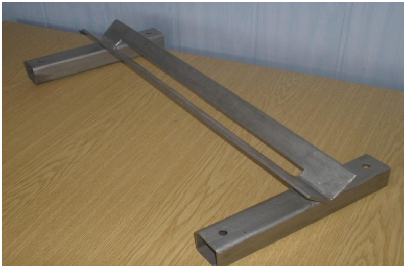
Пристосування для механічного розпилювання квадратних брусків по діагоналі
