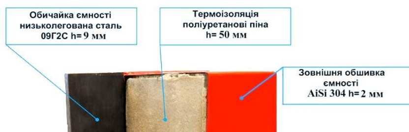
Рис. 1. Будова поперечного перерізу цистерни
