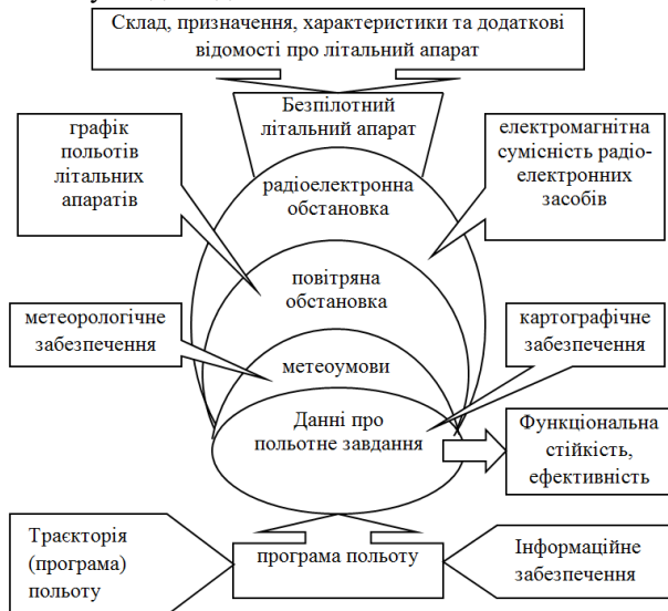
Рис. 1. Функціональна схема роботи безпілотного літального апарата
