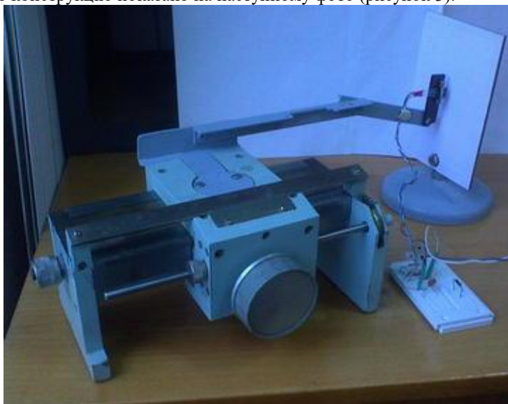
Рис.3.Лабораторна установка для дослідження відбивних властивостей оптопарі
