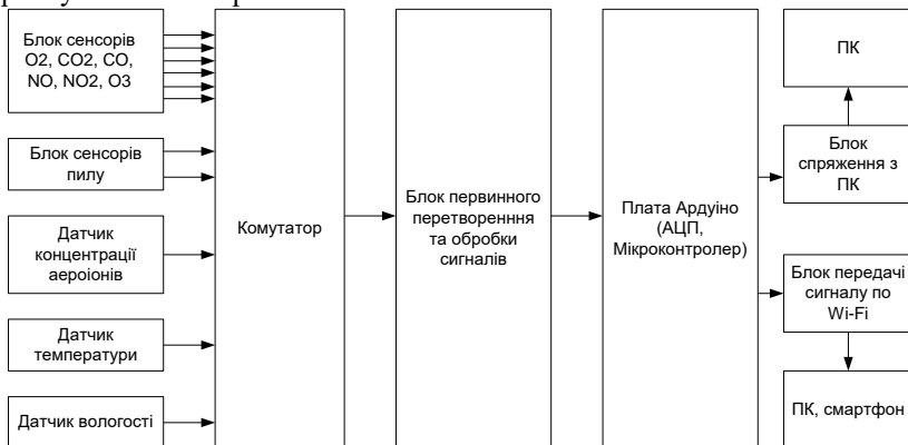
Рис. 1. Схема системи моніторингу якості повітря
